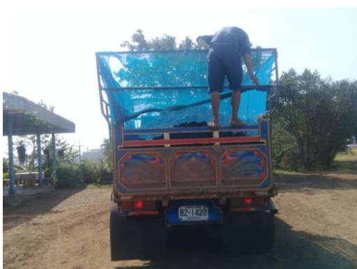
รูปที่ 32 รถบรรทุกกากตะกอนหมักกรองและเถา มีการปิดคลุมด้วยผ้าใบ
