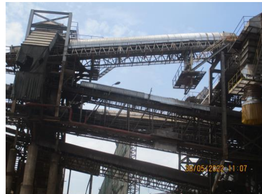
รูปที่ 8 ระบบสายพานลำเลียงแบบปิด
