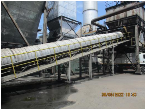
รูปที่ 8 ระบบสายพานลำเลียงแบบปิด
