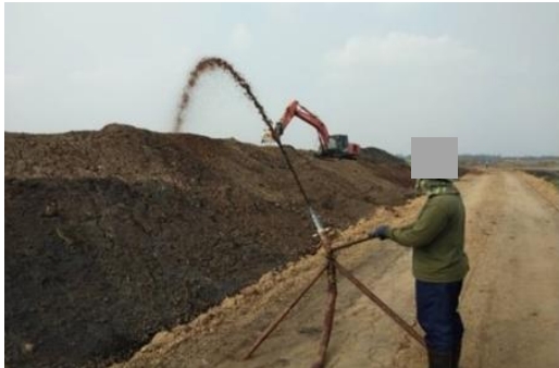
รูปที่ 27 การฉีดเชื้อจุลินทรีย์ดับกลิ่น บริเวณลานกองกากตะกอนหมักกรองและลานกองเถ้า
